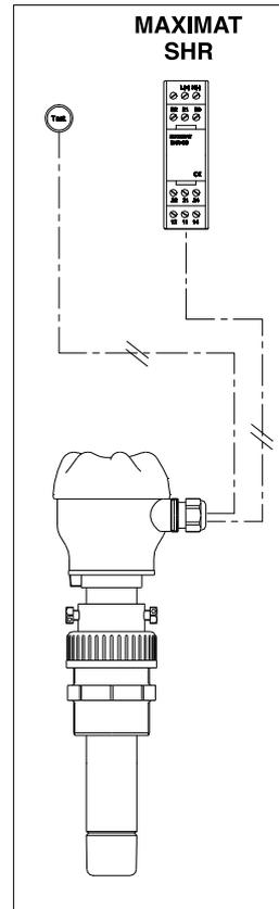
Conexión a través del relé de potencia CST
