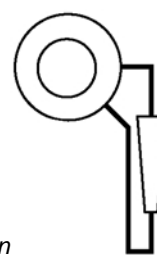
Colocación HB Circulación horizontal indicador vertical-abajo
