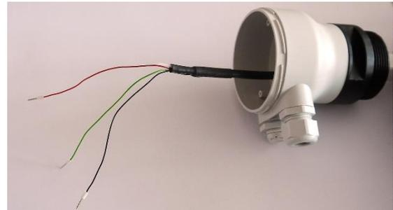
3/ Atar la abrazadera de plástico al cable del sensor para aliviar la tensión futura
